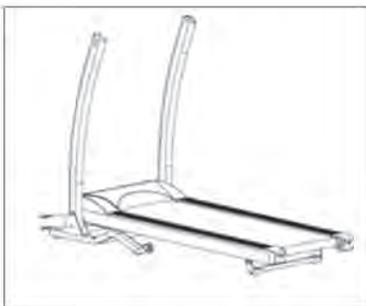
2. Установите стойки строго вертикально и закрепите их в таком положении, используя инструменты №3.
