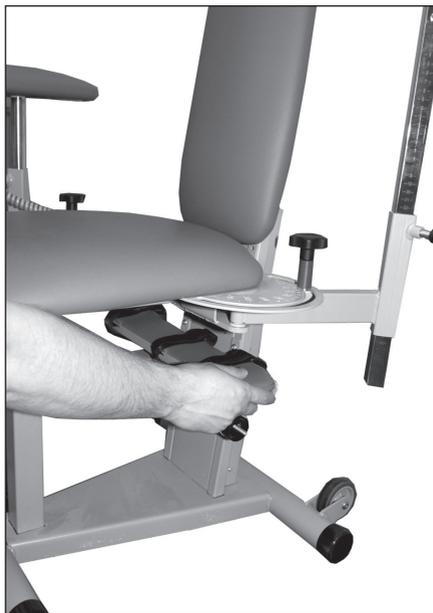
б) Для установки Устройства необходимо снять механизм переворота №22, открыв фиксатор № 29 механизма переворота от храпового механизма. Во время установки Устройства необходимо следить, чтобы пружина, находящаяся внутри фиксатора, осталась в храповом механизме.
